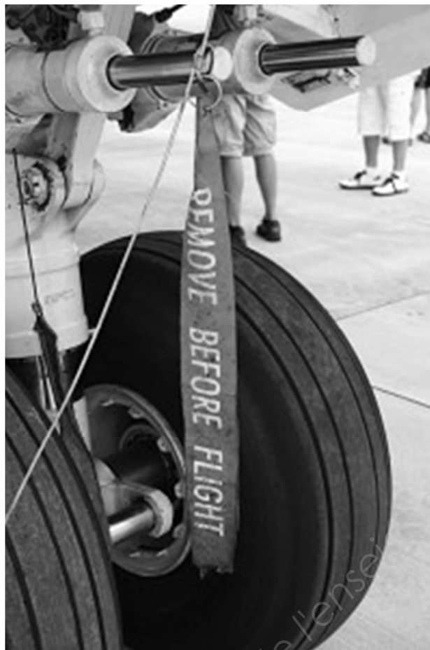
Figure 3 : exemple de flamme « Remove before flight »
