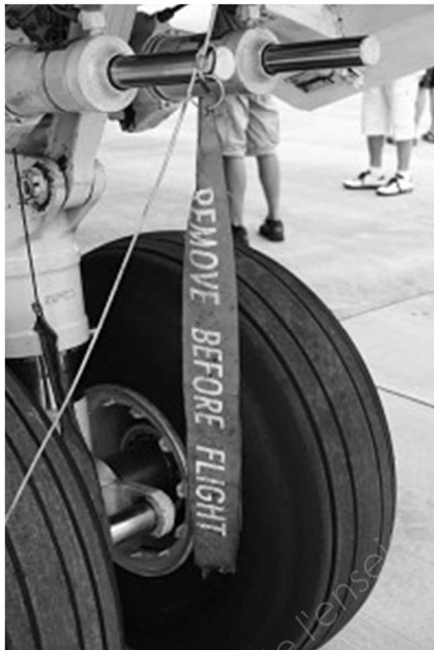
Figure 3 : exemple de flamme « Remove before flight »
